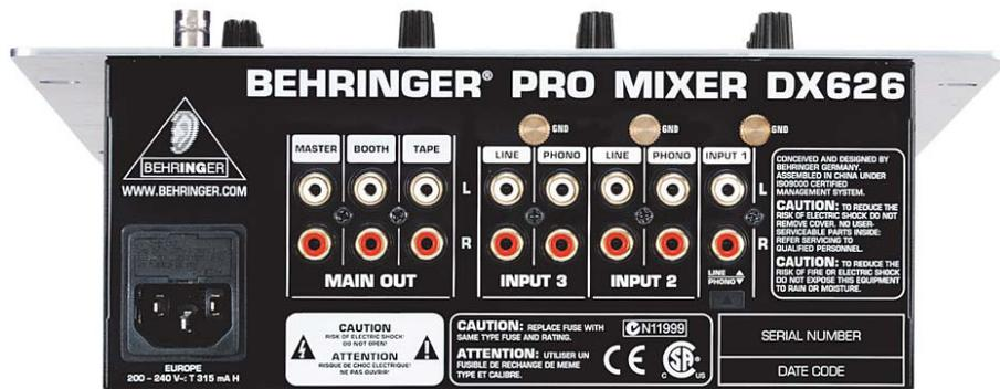
**Master:** Anschluss Cinch auf XLR Kabel (Anschluss Tonanlage)
