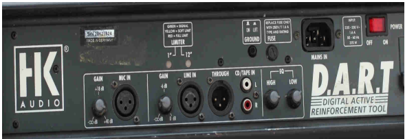
"Audio Output" des Karaoke Players mit Cinch Kabel zum Lautsprecher "CD/Tape In"
