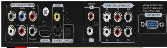
"Audio Output" des Karaoke Players mit Cinch Kabel zum Lautsprecher "CD/Tape In"
