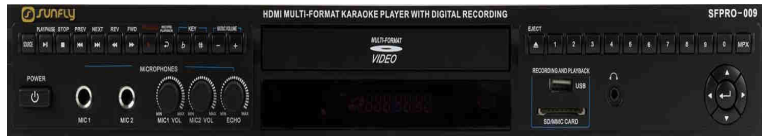
"Mic2" mit 6,35mm Klinke auf XLR Kabel, dann XLR Kabel, dann Mikrofon "Mic1" mit 6,35mm Klinke auf XLR Kabel, dann XLR Kabel, dann Mikrofon
